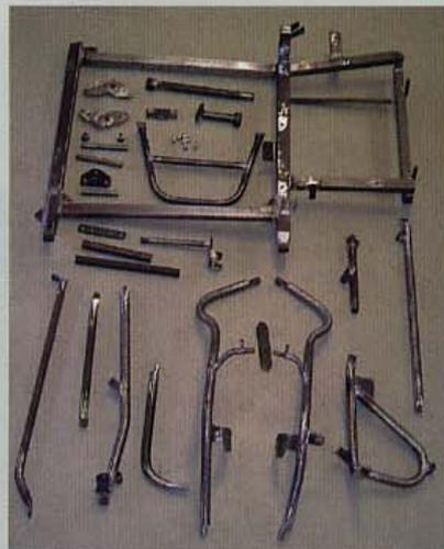
Das sind alle Stahlteile, die für den Gespannubau der Buell angefertigt werden müssen.
