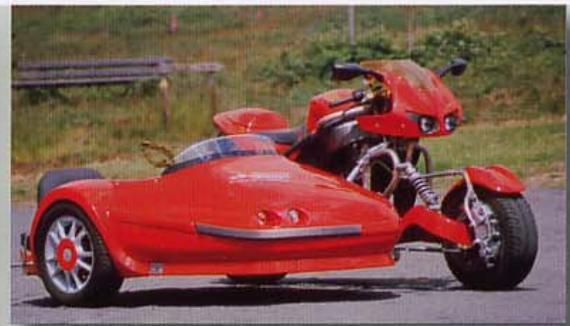
Die Buell XB 12 R Firebolt ist sicher eines der ungewöhnlichsten Motorrader, die dieses Jahr für Gespannbetrieb verpflichtet wurden. Das Projekt wurde von Buell mit dem Motorrad unterstützt.
