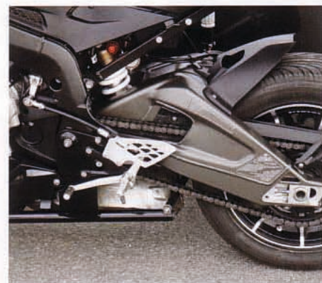
Angepasst: BMW-Monoshock mit härterer Feder und um 60 Prozent erhöhter Dämpfung.
