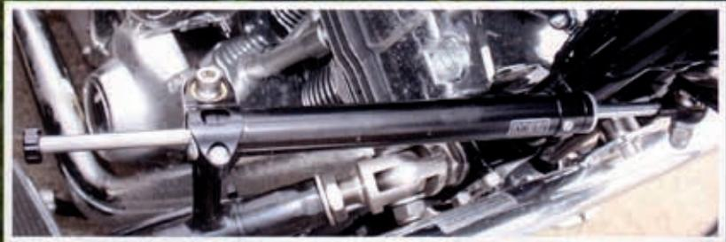
Die externe Federbeinverstellung ermöglicht die schnelle Anpassung an den jeweiligen Beladezustand. In Linkskurven verbreitert sich durch Einfedern die Spur um bis zu 30 mm, wodurch sich die Kippgefahr verringert
