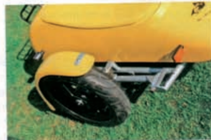
Für den Transportbeiwagen reicht eine geschobene Schwinge mit Gummi-Parabelfeder als Federelement.
