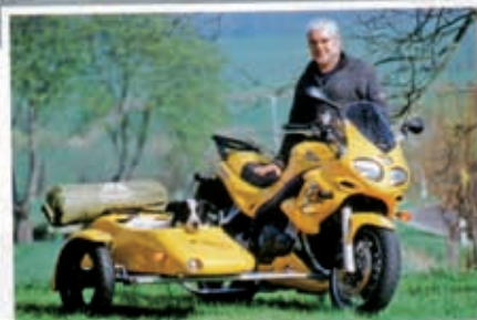
Das Bruno-Midi-Transport-Boot hat die Abmessungen 1300 x 480 x 340 Millimeter. Das ergibt ein Packvolumen von über 200 Litern. Der Transportschwenker hat gegenüber Anhängern einen entscheidenden Vorteil: Es gibt keine Geschwindigkeitsbeschränkung.
