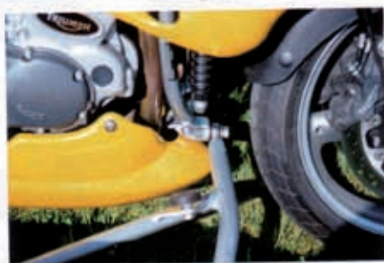
Die Drehachse liegt in der Fahrzeuglängsachse des Motorrades.
