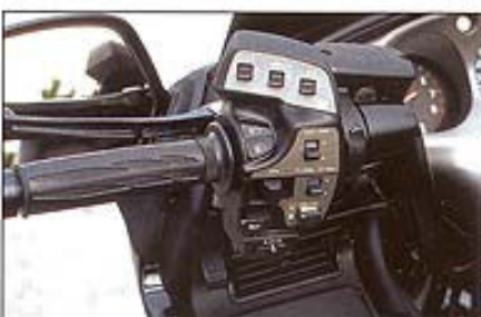
Die Schaltereinheit für das Stereo-Radio ist bedienungsfreundlich neben dem linken Lenkergriff platziert. Der Kassettenrecorder wurde leider wegrationalisiert.
