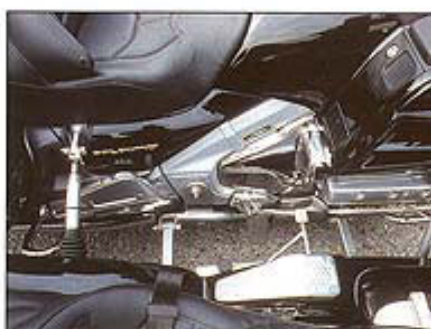
Die Beiwagenbremse wird über ein Mitnehmerpedal aktiviert. Das erleichtert die Demontage des Bootes zum Solo fahren.
