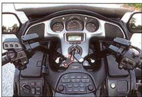
Komplett ausgestattet präsentiert sich das Cockpit. Der Rückwärtsgang wird nun per Knopfdruck an der rechten Schaltereinheit geschaltet.
